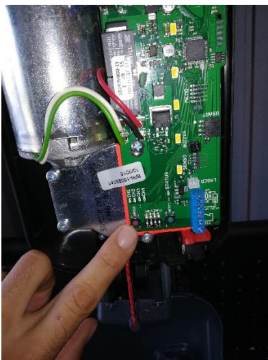
Druk op knopje radio (max 1 seconde) openstellen van de ontvanger
