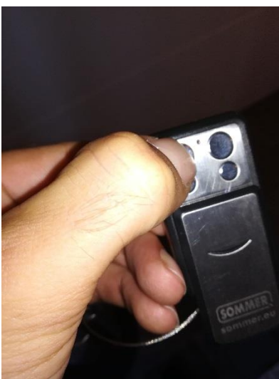
Druk binnen de 15 seconde na openstellen van de ontvanger op het gewenste knopje van je afstandsbediening gedurende 3 seconde
