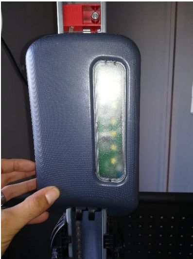
Kapje demonteren van motor (bakje met led verlichting in)
